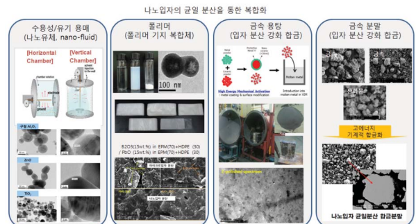
[그림 6] 나노입자의 다양한 용매로의 균일 분산을 통한 복합화 기술
