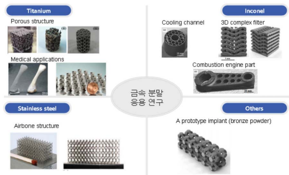
[그림 8] 금속분말의 종류에 따른 레이저 용융 공정 기술 적용 예
