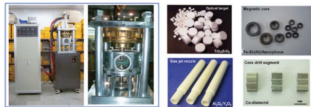
[그림 5] 전자기 펄스성형 장비 및 실제 성형 부품
