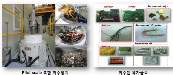
[그림 8] 식품 포장재 및 젤리 케이블에서의 유가금속 회수 장치 및 회수된 유가금속
